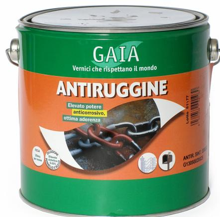
Per la protezione di manufatti in ferro soggetti alla corrosione ed alla ruggine. Si applica dopo avere accuratamente eliminato la calamina, mediante accurata pulizia manuale o per mezzo di sabbatura. A base di resine alchidiche lungo olio, fosfato di zinco e pigmenti inorganici. Essendo costituito da prodotti – resine e pigmenti – inibitori di ruggine, crea una barriera tra la superficie del metallo e l'ambiente esterno.
